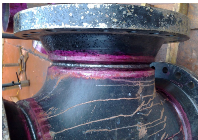
Figura 3.4 – TE com solda de raiz.
