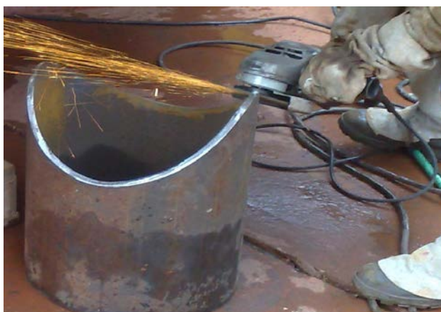
Figura 3.3 – Preparação do chanfro em “V”.
