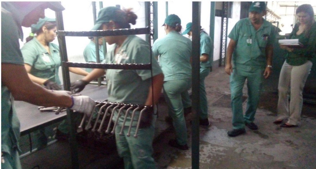
Figura 4.4 - Organização das peças no suporte para secagem antes da pintura.
