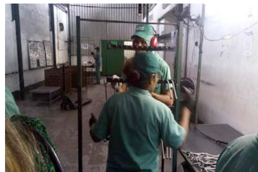
Figura 3: Organização das peças no suporte para secagem antes da pintura.
