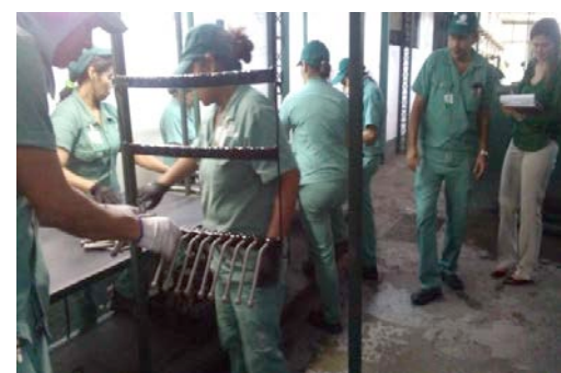
Figura 3: Organização das peças no suporte para secagem antes da pintura.
