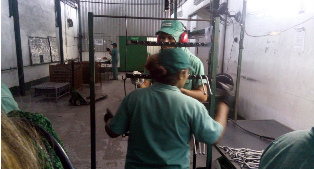
Figura 4.3 - Organização das peças no suporte para secagem antes da pintura.
