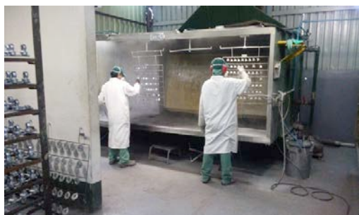
Figura 5: Fotos do processo de pintura. Fase 4 – Processo de secagem – Após a pintura, as peças passam pela estufa para secar.
