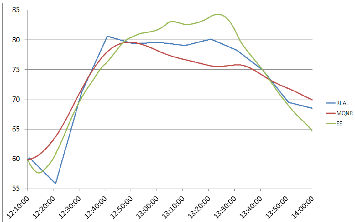
Figura 6.1 – Comparação entre estimação MQNR e em Espaço de Estados do Nível do Tubulão
