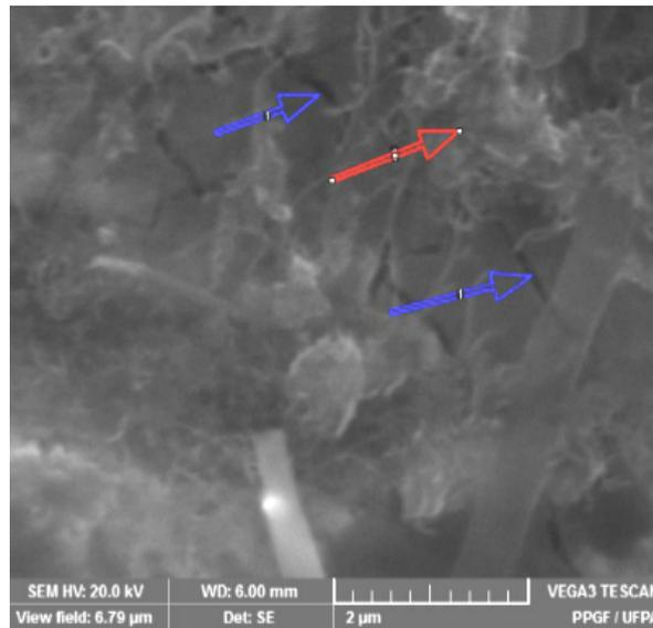
**Figura 4.14** - Imagem da amostra de alumínio incorporada com NTC (amostragem 2). Ampliação 20370x.
