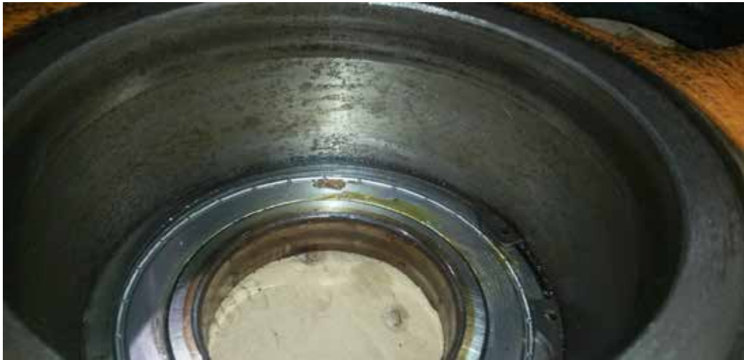
Figura 3.5 – Primeira etapa de Desmontagem do Sistema de Embreagem do Equipamento PAL-07.
