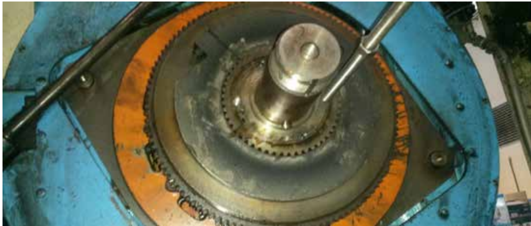
Figura 3.7 – Terceira etapa da Desmontagem do Sistema de Embreagem do Equipamento PAL-07.
