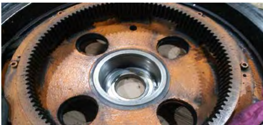
Figura 3.6 – Segunda etapa da Desmontagem do Sistema de Embreagem do Equipamento PAL-07.
