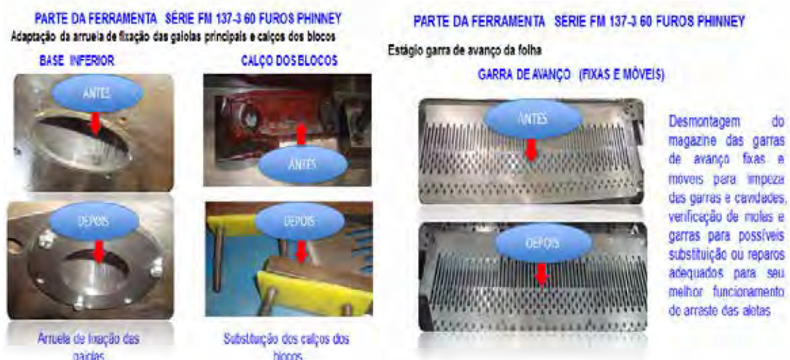
Figura 3.3 – Manutenção Preventiva no Ferramental do Equipamento PAL-07. Fonte: EMPRESA ALFA (2015).
