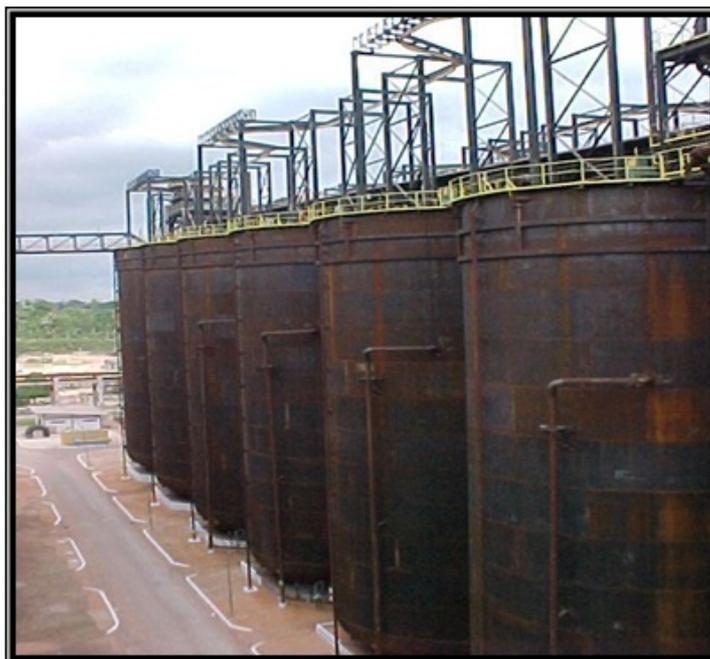
**Figura 2.17** – Tanques de precipitadores intermediários da Hydro Alunorte. Fonte: AMARAL (2004).
