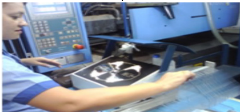
Figura 4.4 - Placa sobre o dispositivo para verificar impurezas.
