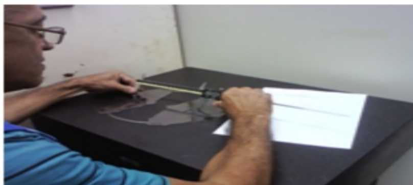
Figura 4.9 - Peças sendo confirmada dimensional na pedra sala do laboratório CQ.
