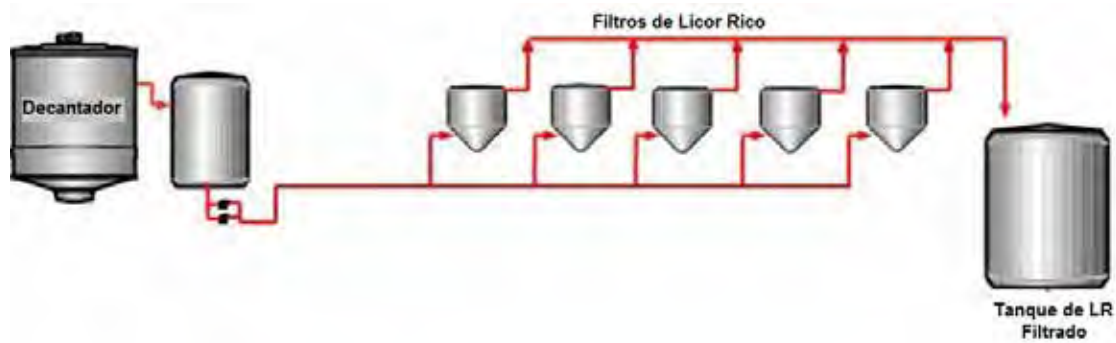
Figura 2.2 - Representação esquemática do fluxo de licor rico passando pelas operações de decantação e filtração.
