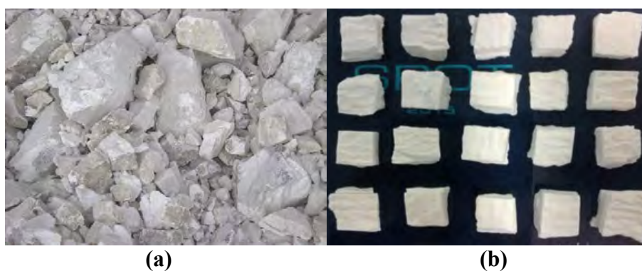
Figura 3.1 - (a) Cal virgem na forma em que é enviada para o moinho; (b) Crostas recolhidas do sistema de recalque dos moinhos e cortadas em formato cúbico.
