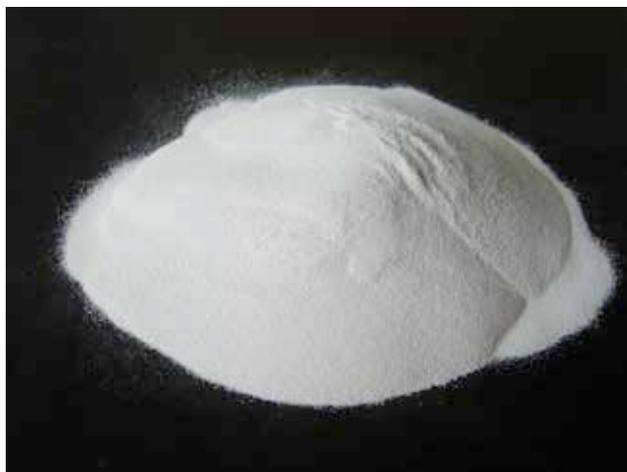
**Figura 2.3** - Alumina obtida através do processo de Bayer. Fonte: HYDRO (2013).
