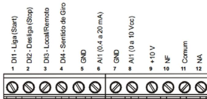
**Figura 3.13** - Conector XC1 do inversor de frequência CFW-10.
