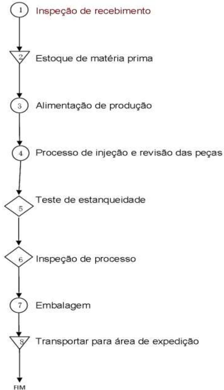
Figura 4.6 - Sequência de Operação de Processo Conforme FCQP.
