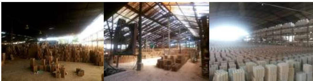
Figura 3.32, 3.33 e 3.34 - Galpão de secagem de tijolos das olarias A, B e C.
