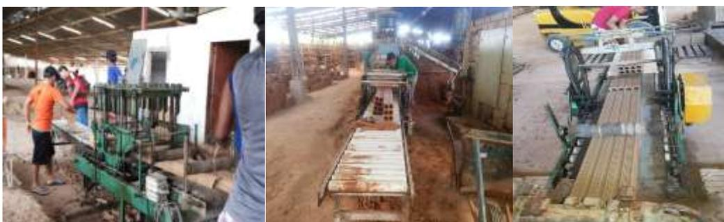
Figura 3.29, 3.30 e 3.31 - Máquinas de corte das olarias A, B e C.
