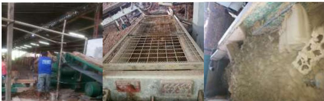
Figura 3.20, 3.21 e 3.22 - Misturador das olarias A, B e C.
