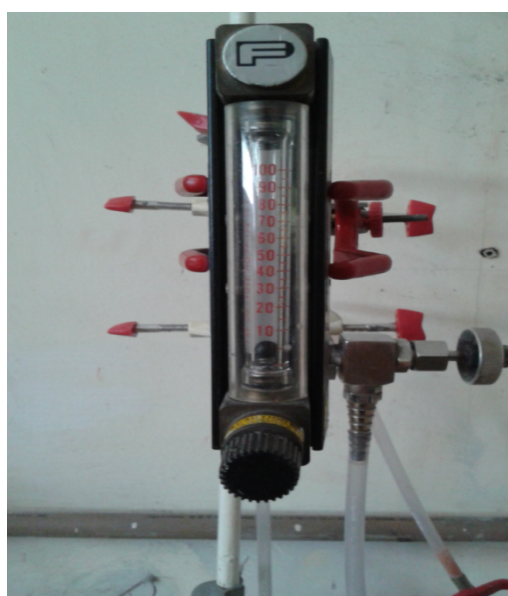
Figura 3.4 - Rotâmetro FISCHER&PORTER modelo 10A 3137.
