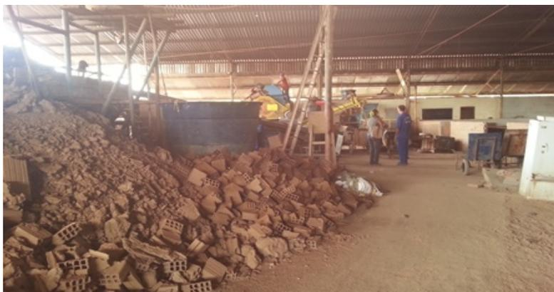
**Figura 3.1** - Os blocos defeituosos ficam dispostos no chão da fábrica.
