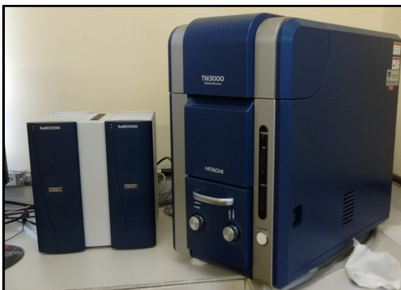
Figura 3.8 - Equipamento para MEV de bancada da marca HITAGUI (modelo TM 3000).
