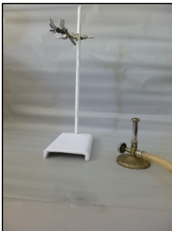
Figura 3.9 - Aparato utilizado para teste de flamabilidade.
