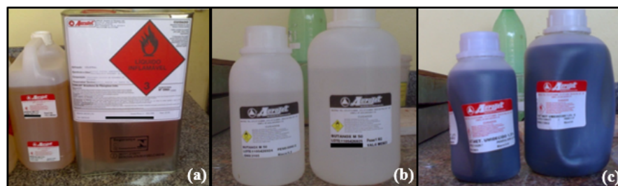
Figura 3.1 - Resina de poliéster insaturado isoftálica (a); Iniciador peróxido de etil-metil cetona (MEK-P) (b); Acelerador de cobalto (c).
