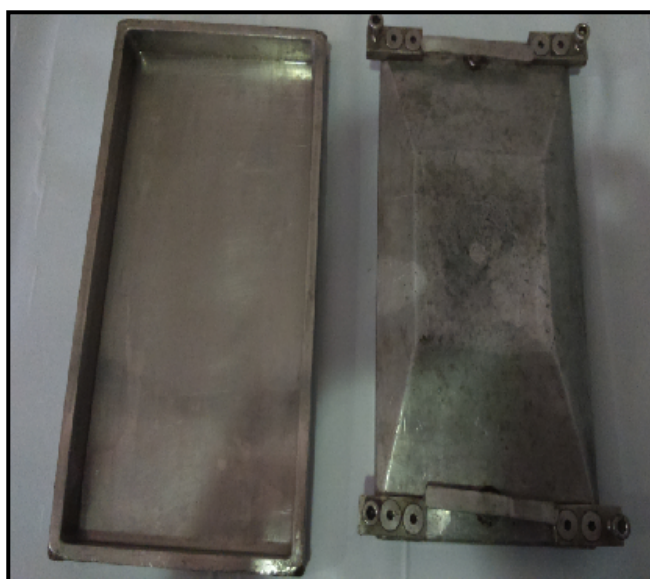
Figura 3.4 - Forma retangular utilizada para a fabricação do compósito.
