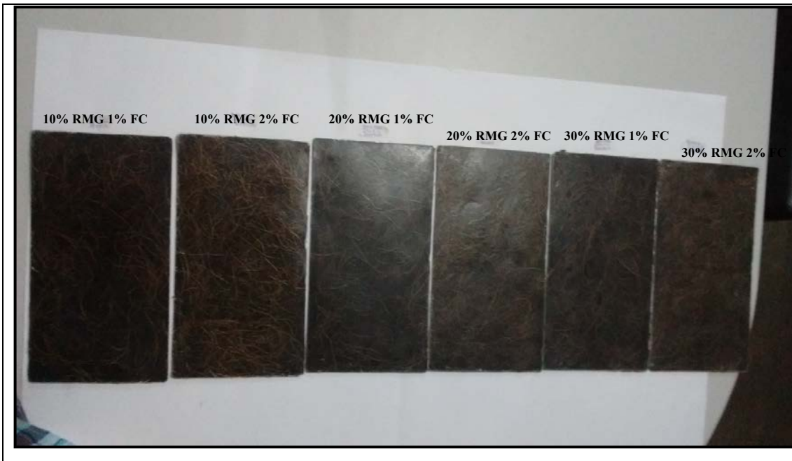
Figura 4.5 - Placas retangulares do compósitos híbridos com resíduo e mármore e granito e 1% fibra de coco.
