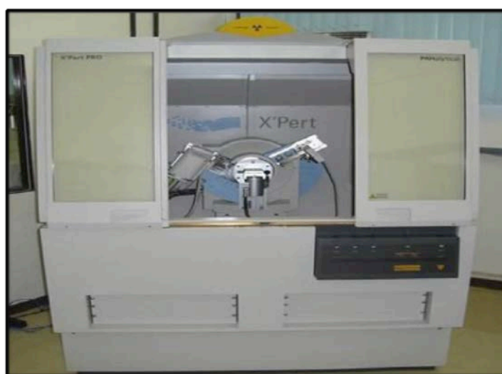
Figura 3.7 - Difratômetro de raio-X, modelo X'PERT PRO MPD (PW3040/60). Fonte: SILVA (2015).
