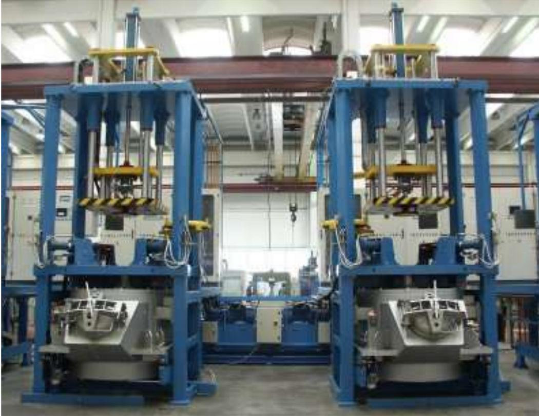
Figura 4.3 - Máquina de fundição por baixa pressão.
