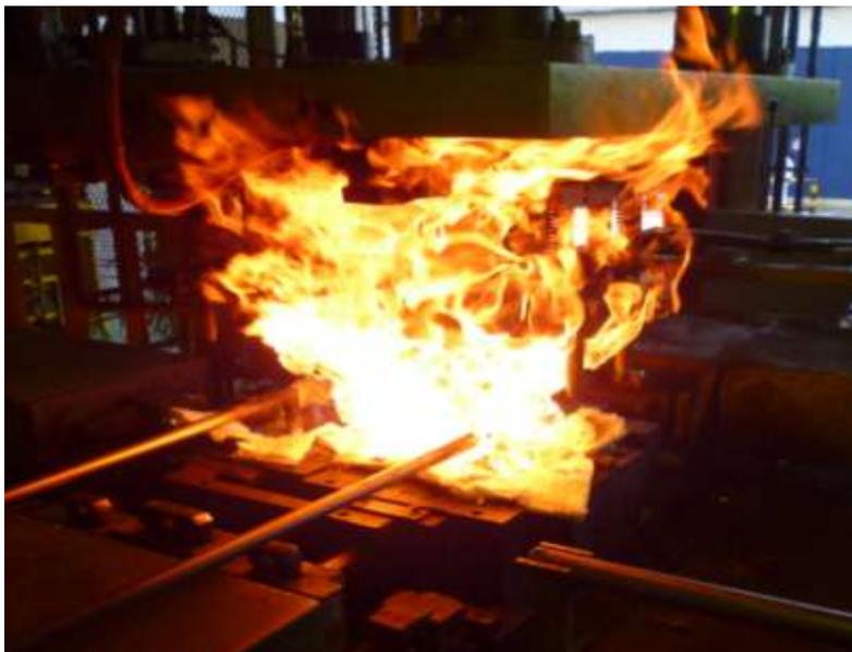
Figura 4.7 - Molde em aquecimento via maçarico.
