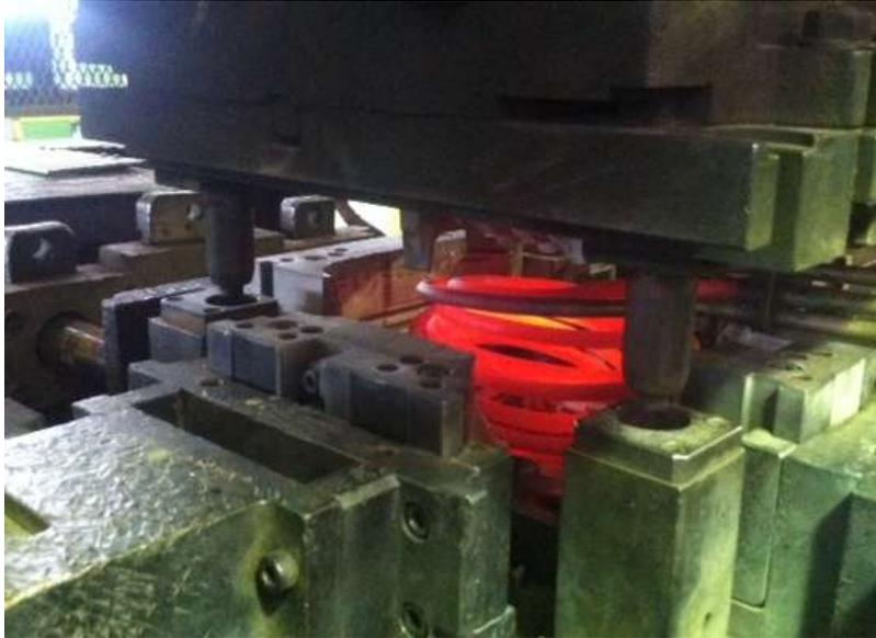
Figura 4.12 - Resistência tubular em operação.
