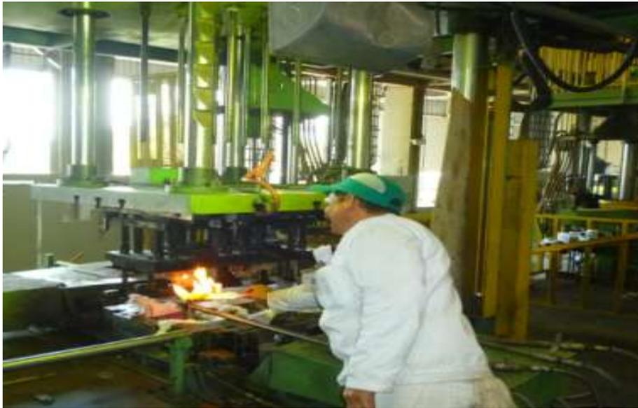
Figura 4.6 - Ignição do aquecedor tipo maçarico.
