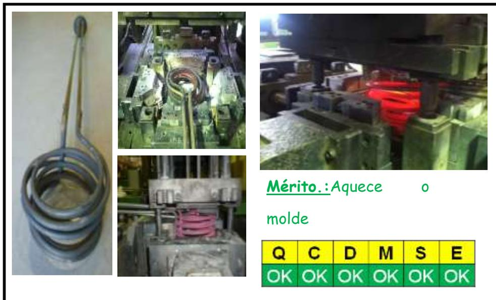
Figura 3.6 - Proposta de desenvolver aquecedor com resistência elétrica.
