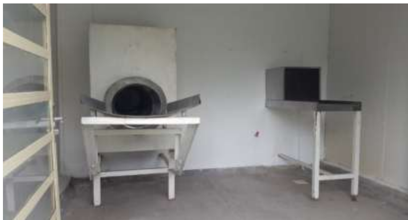
Figura 4. 27 - Cilindro de lavagem e descontaminação da matéria prima e passagem de utensílios para a parte interna do setor de manipulação.
