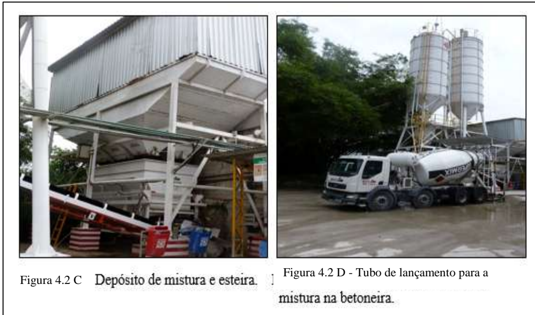
Figura 4.2 - Método de produção do concreto (Continuação).
