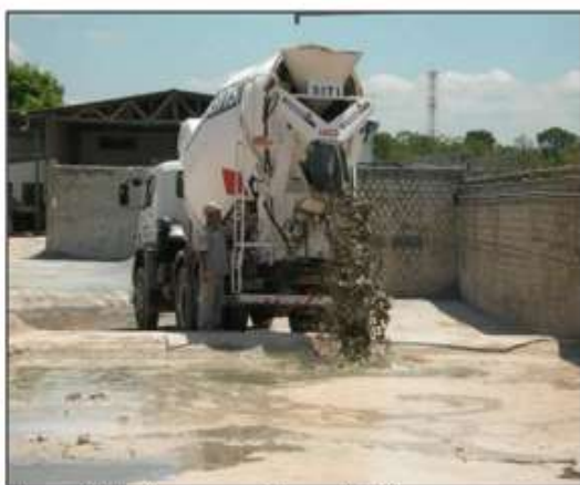
Figura 5.3 A- Lavagem do caminhão
