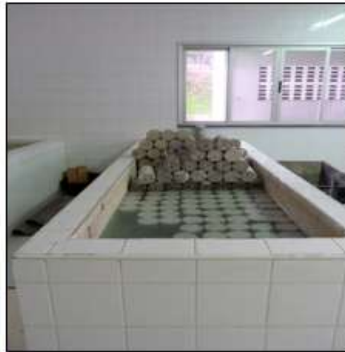
Figura 4.3 B - Reservatório para cura de corpo de prova.
