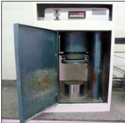
Figura 4.3 C - Equipamento medidor de resistência e compressão.
