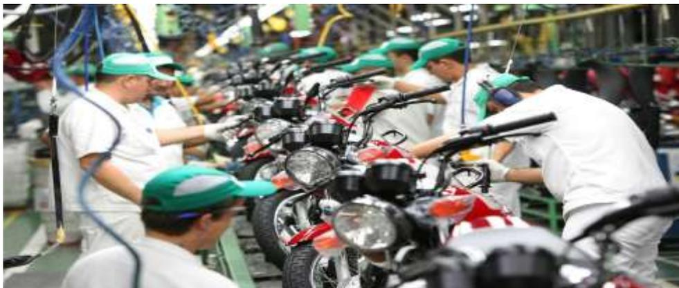
Figura 2.15 - Arranjo Físico Linear ou por produto - Fábrica de Motocicletas.
