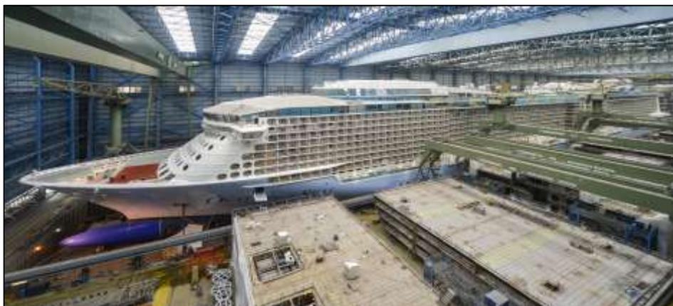
Figura 2.7 - Arranjo Físico posicional - Fábrica de Navio.
