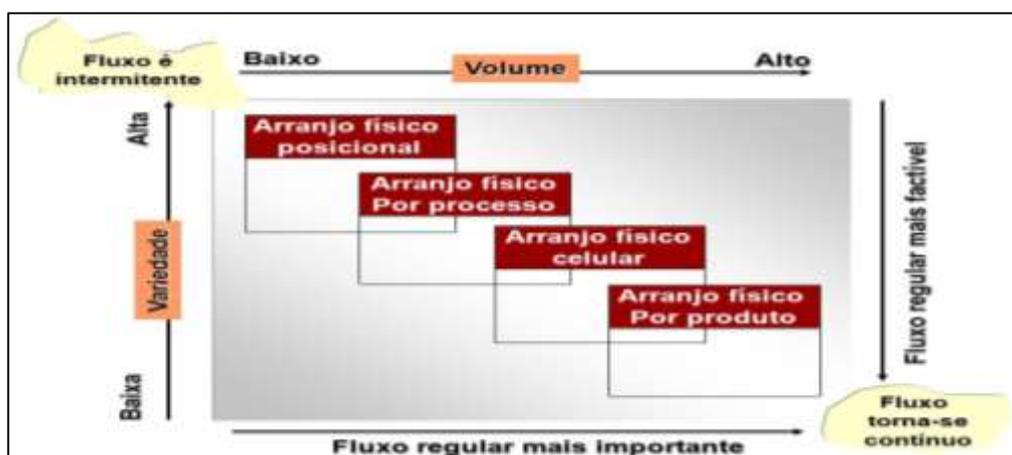
Figura 2.4 - Posição do arranjo físico em relação ao volume, variedade e fluxo.
