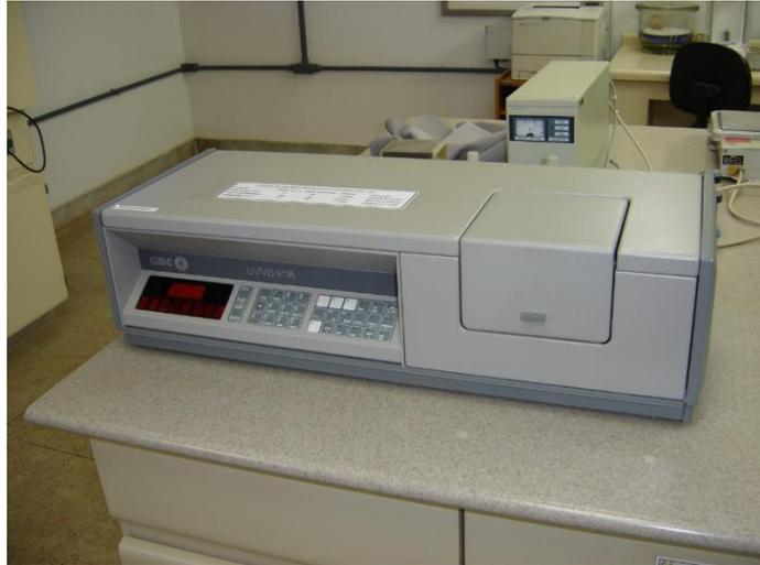
Figura 3.4 - Espectrofotômetro UV.
