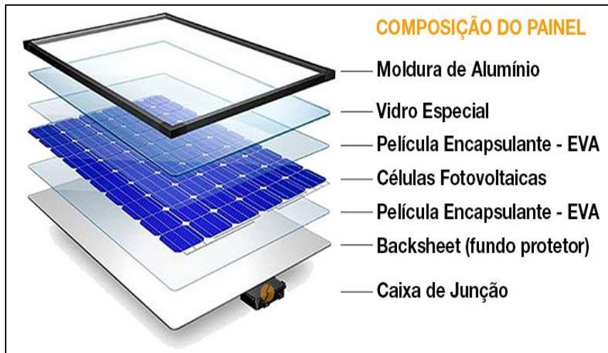
Figura 2.12 - Composição Básica do Painel Fotovoltaico. Fonte: NEOSOLAR (2016).
