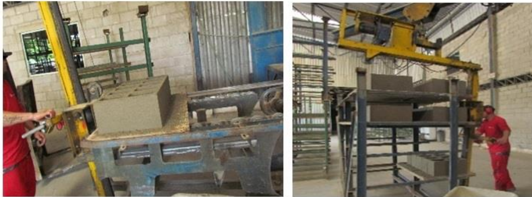
Figura 4.18 - Funcionário medindo o bloco e levando para o processo de cura.
