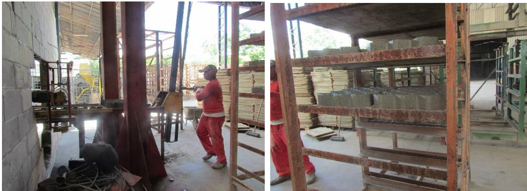
Figura 4.14 - Funcionário tirando o bloco e estante de ferro onde ficam os blocos de concreto.
