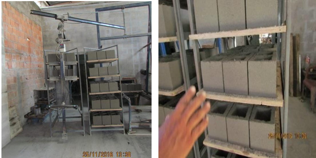
Figura 4.5 - Pinça Elétrica. Estante de ferro, que são organizados os bloco de concreto.
