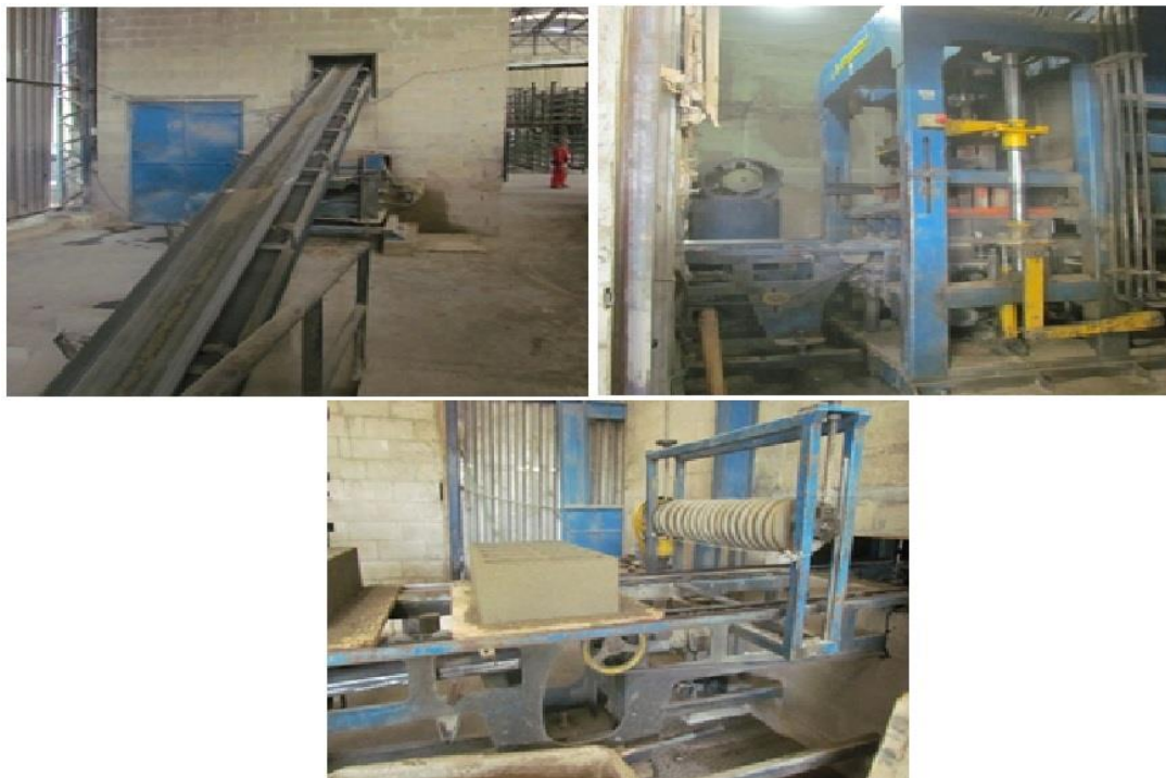
Figura 4.17 - Levando a massa pela esteira. Máquina utilizada pela Empresa B. Bloco sendo concluído.
