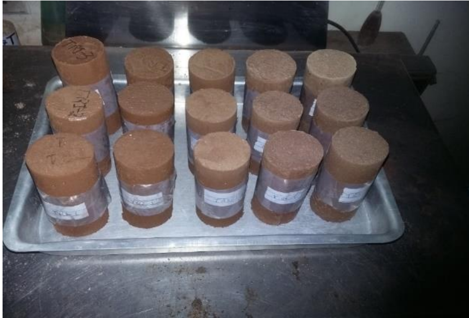
Figura 3.9- CPs após 28 dias de cura
