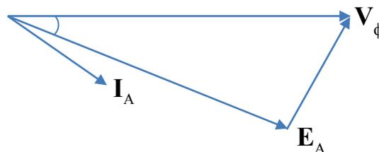
Figura 4.13 – Motor síncrono operando com fator de potência atrasado.
