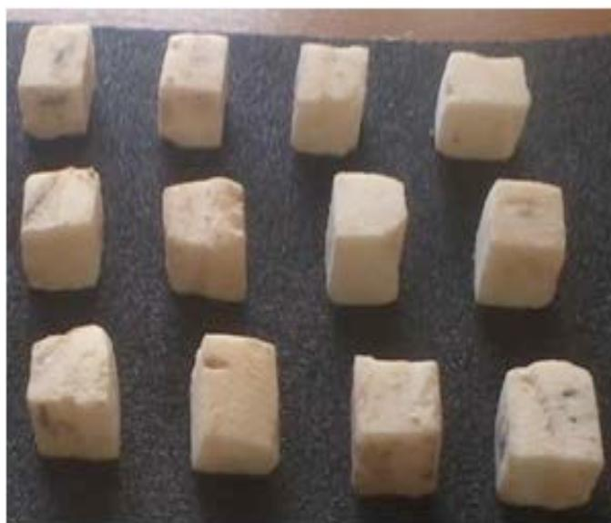
**Figura 3.8** - Amostras da crosta de hidrato do tanque espessador utilizadas nos testes para determinação do fator de consumo de soda e testes para identificação das influências no processo de dissolução.
