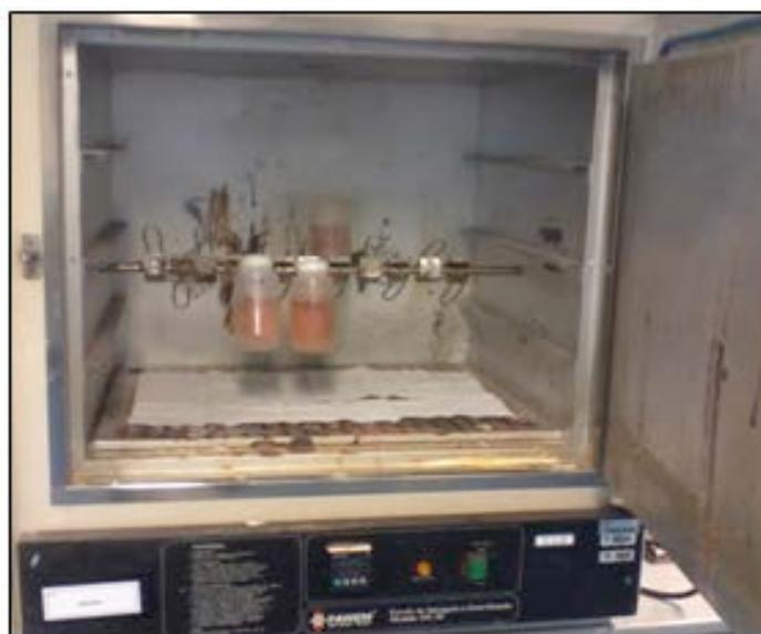
**Figura 3.6** - Estufa com dispositivo giratório.
