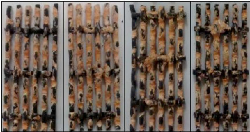
Figura 4.21 – Aspectos das condições em que ficaram as amostras das telas metálicas após lavagem cáustica de 15 horas.
