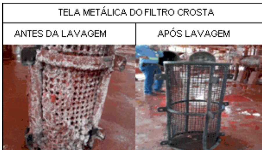
**Figura 4.25** - Fotografia da tela metálica do filtro crosta antes e após a lavagem cáustica.
