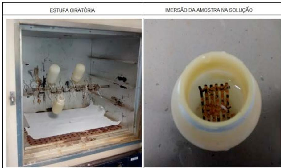
**Figura 3.14** - Aparato (estufa, frascos plásticos e tela metálica) utilizado nos testes.
