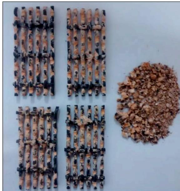
Figura 4.22 – Aspectos das condições em que ficaram as amostras das telas metálicas após lavagem cáustica de 15 horas com a quantidade total de crosta retirada.
