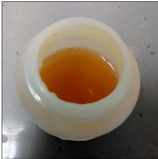
**Figura 4.23** – Aspecto da solução cáustica após lavagem de 15 horas da amostra da tela metálica.
