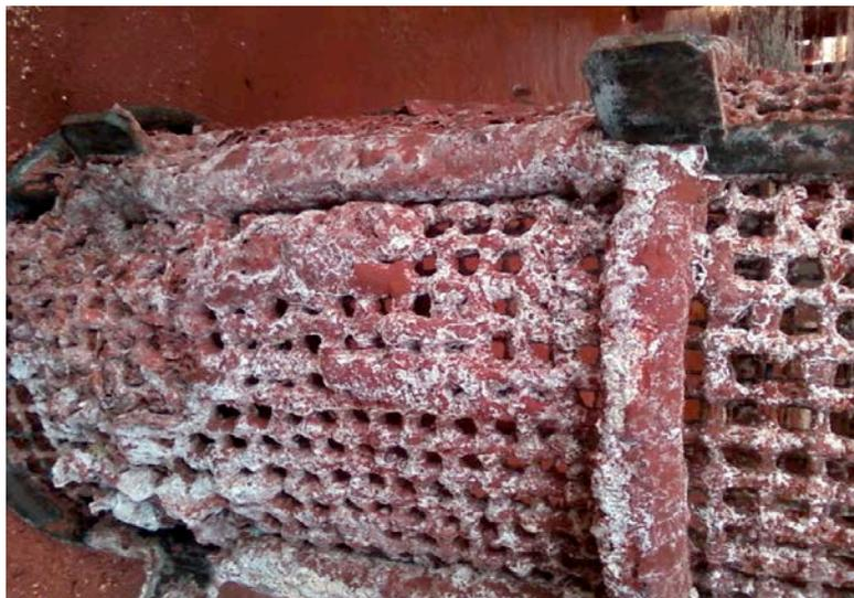
**Figura 3.15** - Tela metálica do filtro crosta antes da lavagem cáustica.
