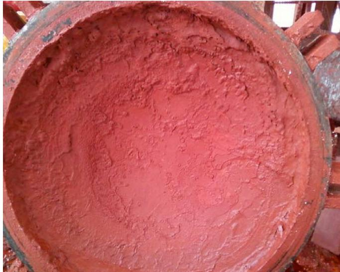
**Figura 3.16** - Interior da tampa do filtro crosta antes da lavagem cáustica.
