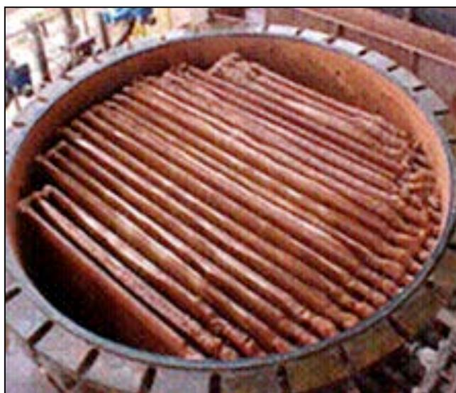
**Figura 3.1** - Filtro de pressão vertical aberto, tendo à mostra um conjunto de tecidos após uma campanha de 120 ciclos de filtração.
