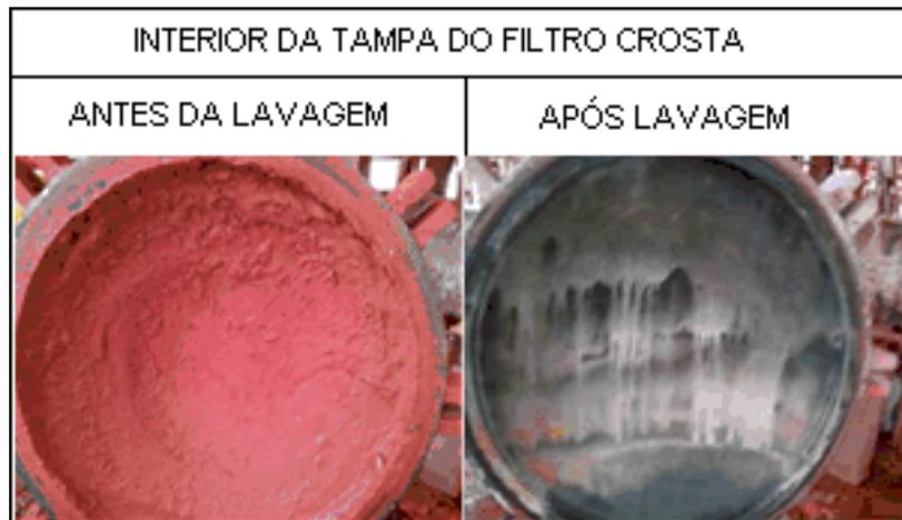
**Figura 4.26** - Fotografia da tampa do filtro crosta antes e após a lavagem cáustica.
