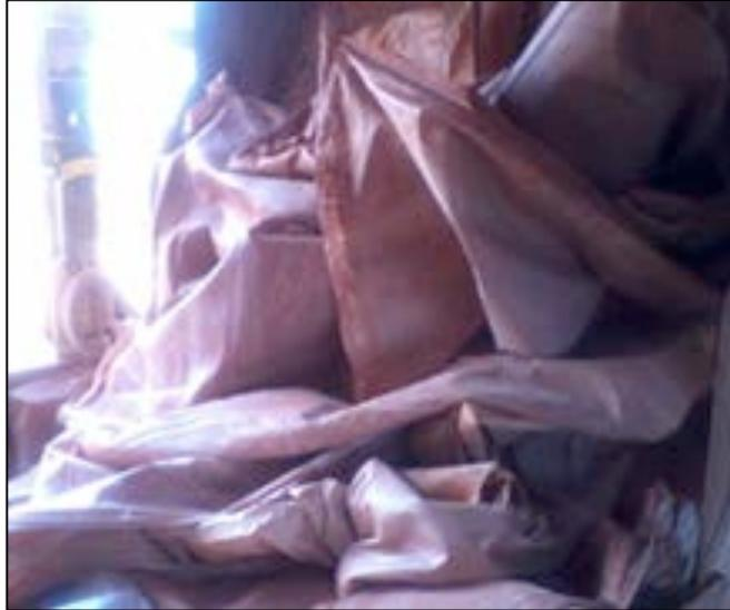
**Figura 3.2** - Conjunto de tecidos/bolsas descartados de um filtro de pressão vertical.
