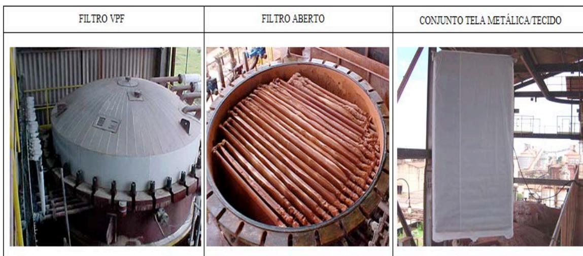
**Figura 3.11** - Sequência fotográfica mostrando um filtro VPF fechado e aberto, juntamente com uma tela metálica revestida com tecido filtrante içada para ser posicionada no filtro.
