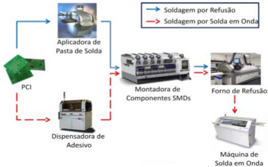
Figura 2.3 – Processo de montagem SMT.
