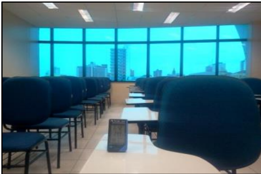
Figura 3.4 - Foto aplicação do Instrumento termo higrômetro.
